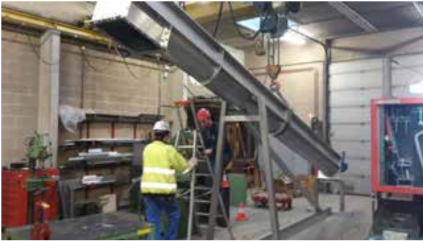
Préparation en atelier de la vis de transport/mélange boue et chaux
