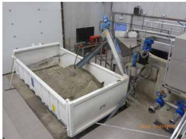
Classificateur avant/après installation du laveur
